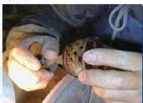
粗摺りよりもだいぶ細かい目のダイヤモンドホイール（目の粗さは300～500番程度）を使います。粗摺りで削ったところに沿ってさらに太くしていきます。金盤に金剛砂を使い削っていた時と比べ、ダイヤモンドホイールによって、より複雑なデザインが可能となりました。
