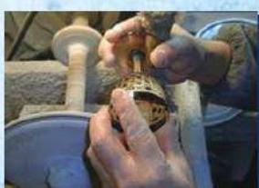
木盤（材質は桐など）や樹脂、フェルトなどを回転させ、研磨剤をつけながらカット面を艶が出るまで最終的に磨き上げます。どんなにカットが良くても磨きが良くなければ切子は引き立ちません。また現在ではここに説明されている「手磨き」に対してフッ酸を主とした薬品の混合液によって全面を溶かし、輝かせる「酸磨き」という磨き方もあります。
