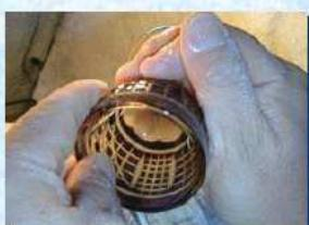
回転する丸砥石で「三番掛け」により削り出した模様の形を整え、加工面をさらに細かく滑らかに仕上げていきます。「石掛け」は削りの最終工程で、これにより全体の図柄が出来上がります。また難易度も高いため仕上がりを左右する重要な工程です。
