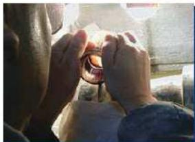
回転する円盤状のダイヤモンドホイール（目の粗さは100～170番程度）をガラスに当て、大きな模様をはじめに削ります。このダイヤモンドホイールはカットの幅、深さ、形などによって様々な種類の刃を使い分けます。
